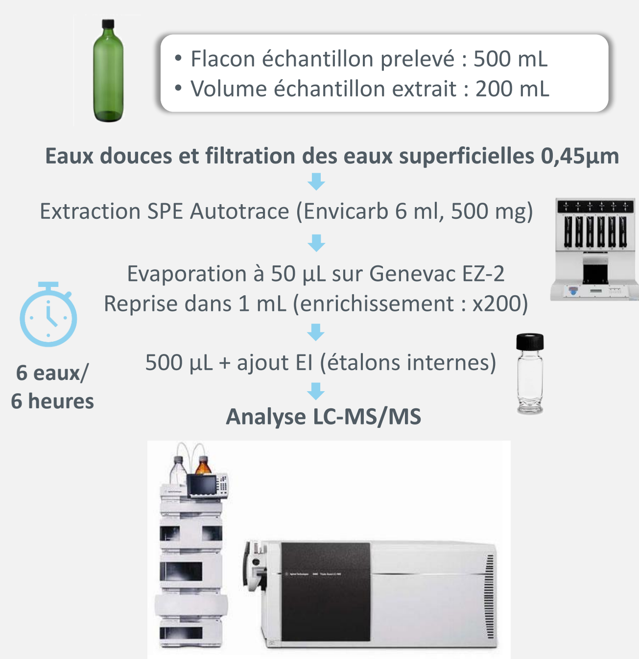
Fig 2. Chaîne Agilent LC 1290 couplé au spectromètre de masse Agilent TQ-6470
